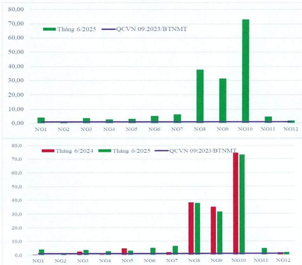
Biểu đồ 2.15. Diễn biến thông số \text{NH}_4^+ trong nước dưới đất tháng 6/2025 và so sánh cùng kỳ năm 2024 (mg/l)
