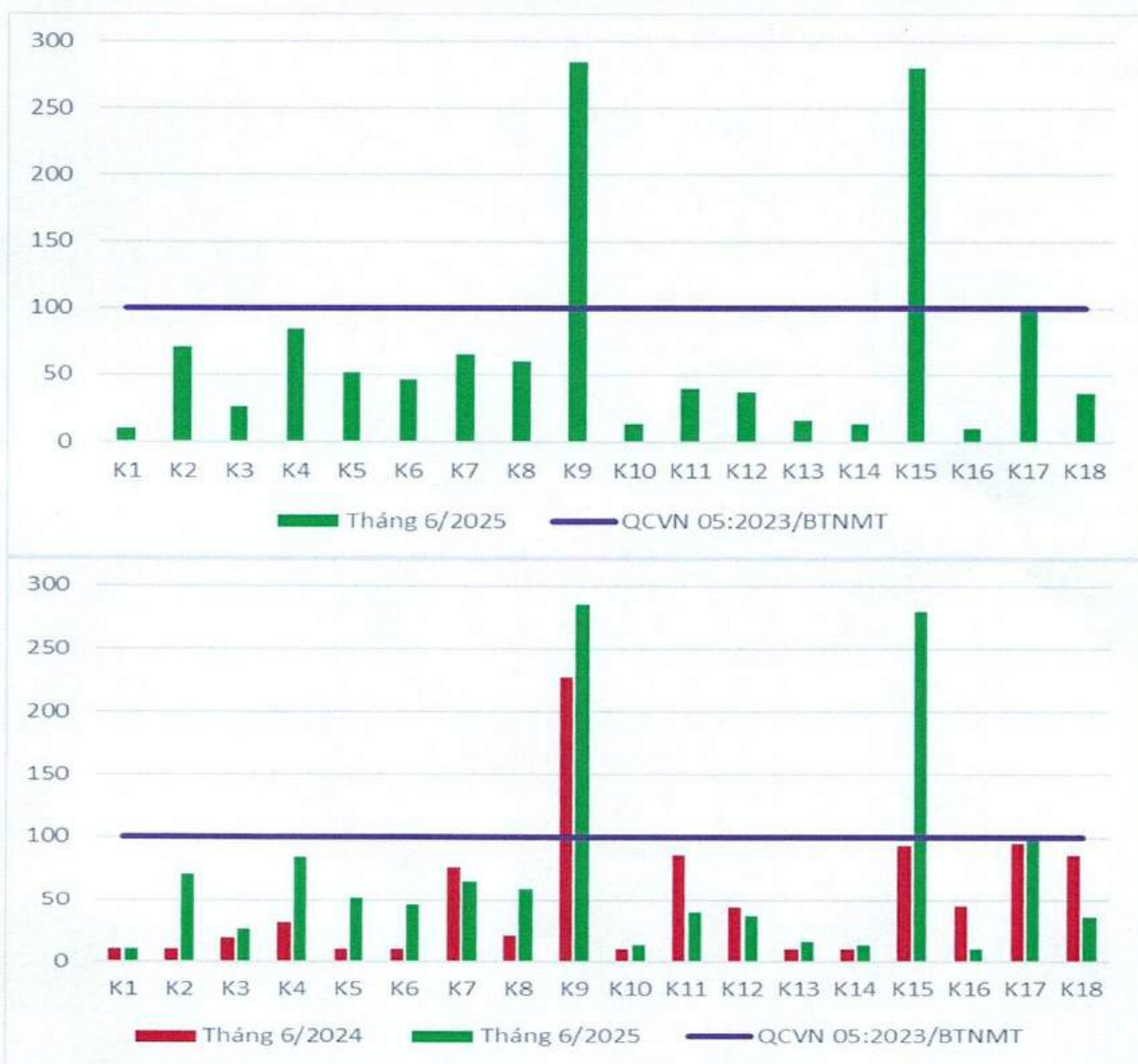
Biểu đồ 2.3. Diễn biến bụi PM_{10} tháng 6 năm 2025 và so sánh với cùng kỳ năm 2024 ( \mu g/Nm^3 )
