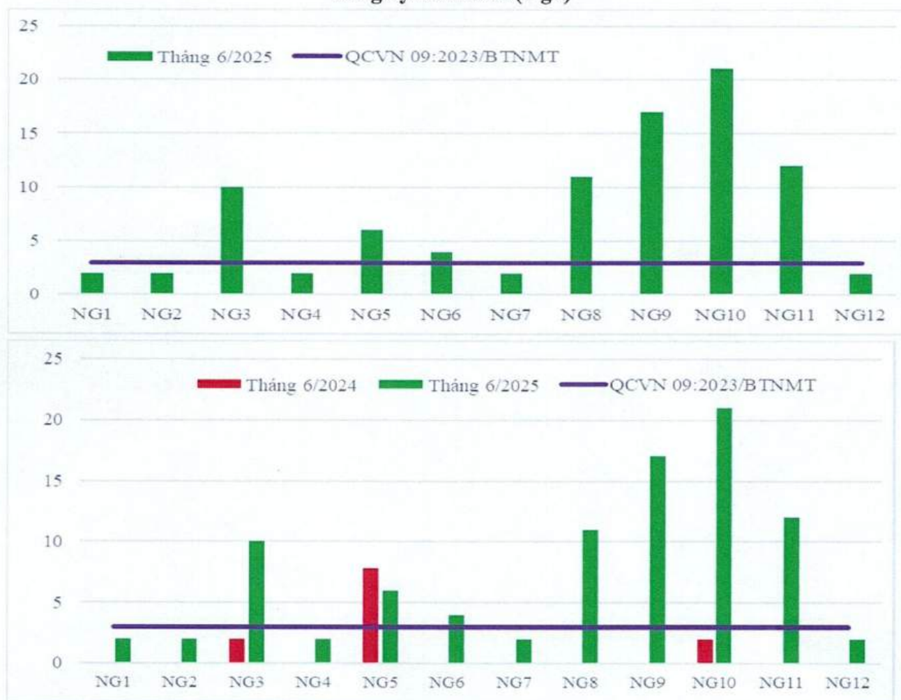
Biểu đồ 2.18. Diễn biến thông số Coliform trong nước dưới đất tháng 6/2025 và so sánh cùng kỳ năm 2024 (mg/l)
