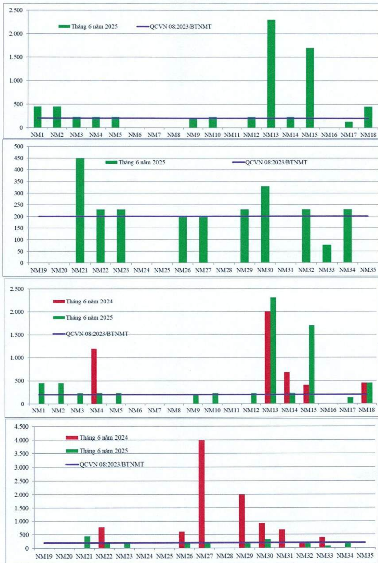
Biểu đồ 2.9. Diễn biến Coliform chịu nhiệt tháng 6/2025 và so sánh với cùng kỳ năm 2024 (MPN/100ml)
