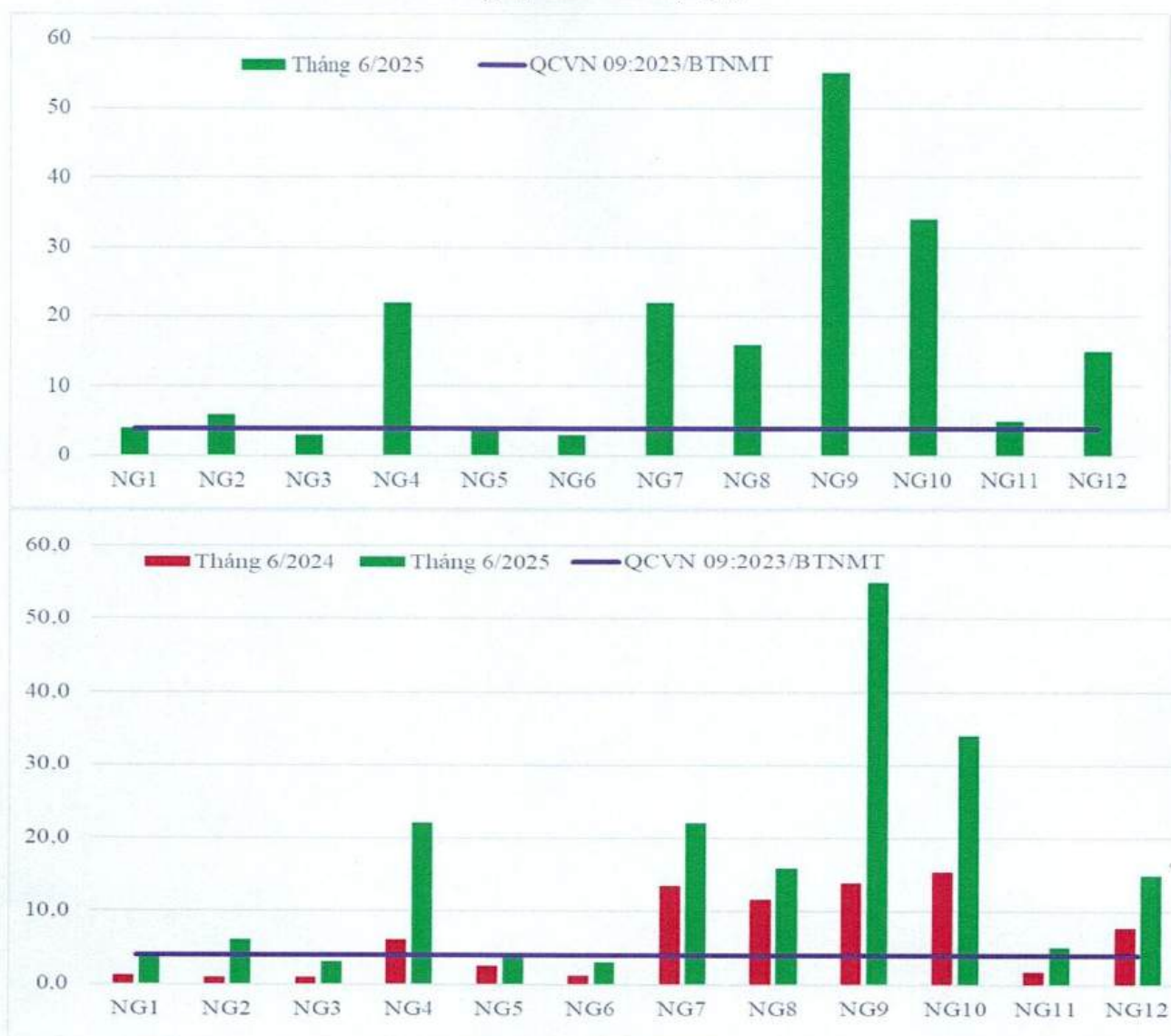
Biểu đồ 2.13. Diễn biến chỉ số Pemanganat trong nước dưới đất tháng 6/2025 và so sánh cùng kỳ năm 2024 (mg/l)
