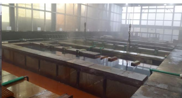
Công đoạn tẩy gỉ
