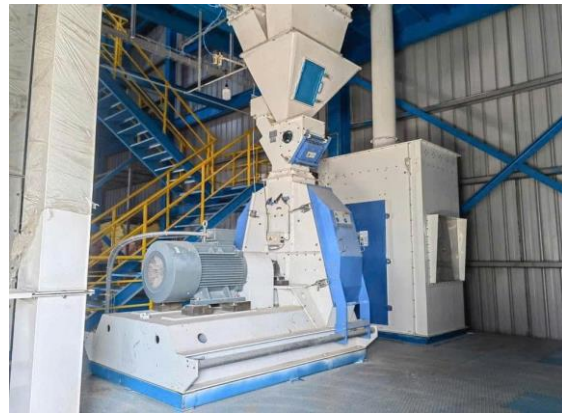
Hình ảnh thiết bị thu hồi bụi bằng túi vải kèm theo máy nghiền
