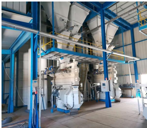
Hình ảnh thiết bị thu hồi bụi bằng cyclone kèm theo của máy ép viên
