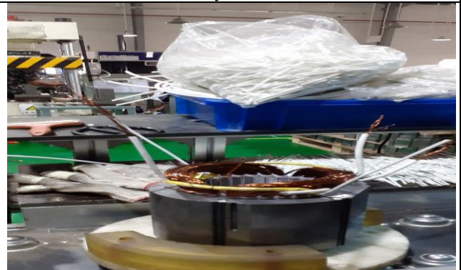
Stato được đặt ống cách điện
