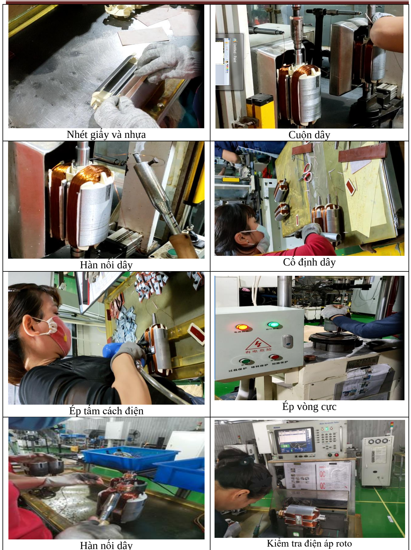
Hình 1.4. Một số hình ảnh về quá trình sản xuất và lắp ráp roto
