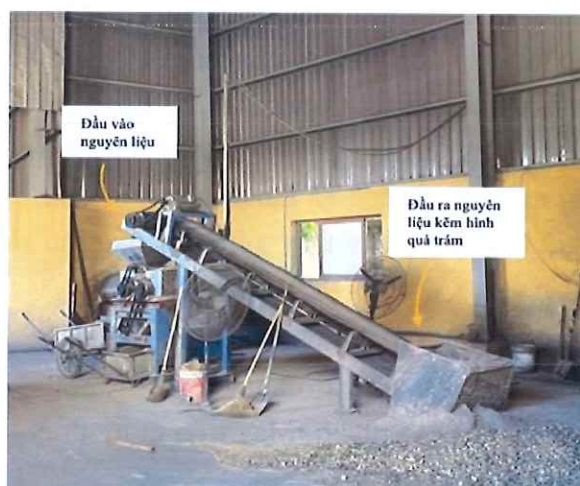
Hình 1.6: Máy ép và nguyên liệu kẽm “quả trám”
