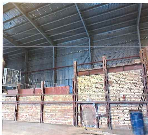
Hình 1.8: Buồng oxy hóa
