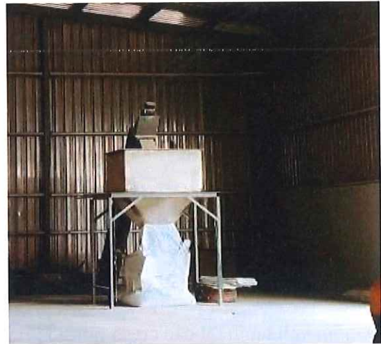
Hình 1.12: Máy trộn bột đóng bao
