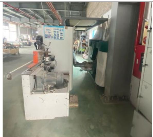
Máy cắt các chi tiết nhỏ để lắp ghép tạo thành cửa
