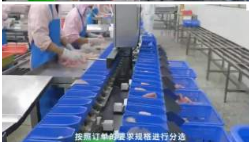
Phi lê được kiểm tra và cân tự động
