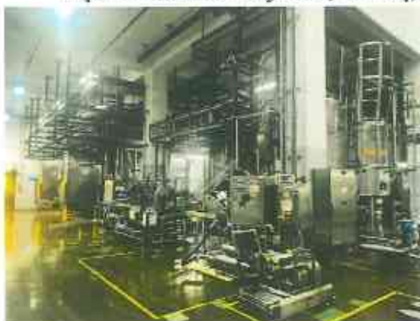
Khu vực hệ thống tiếp liệu, vận chuyển và chứa nguyên liệu thô dạng lỏng (gluco, mạch nha, dầu cọ)
