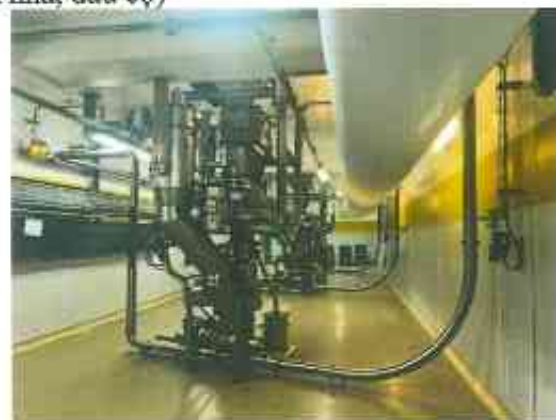
Khu vực hệ thống tiếp nhận và vận chuyển nguyên liệu thô dạng bột (đường, cacao,...)
