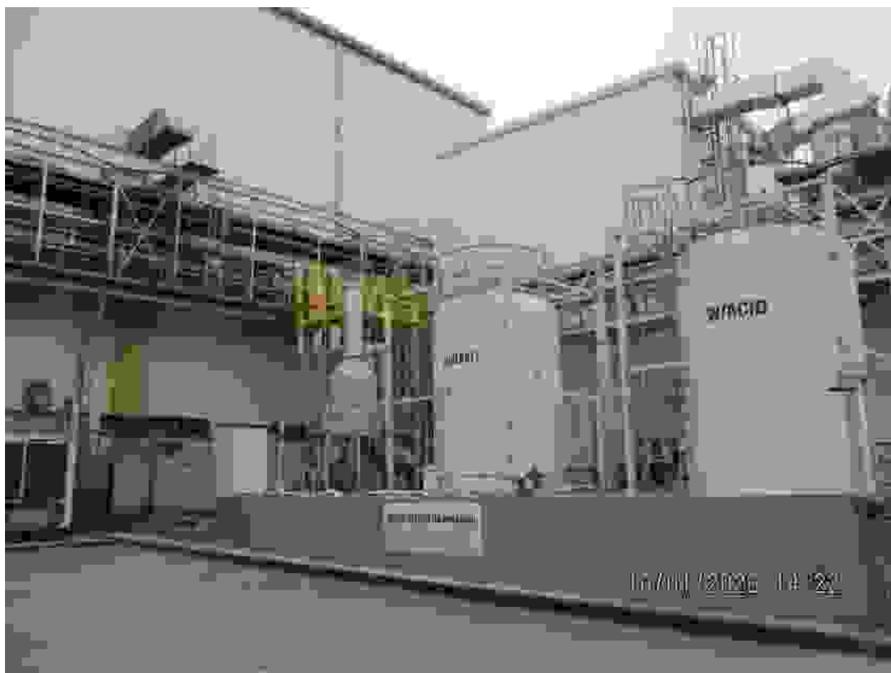
Hình 3.13. Hình ảnh hệ thống HTXL khí thải bằng H_2SO_4
