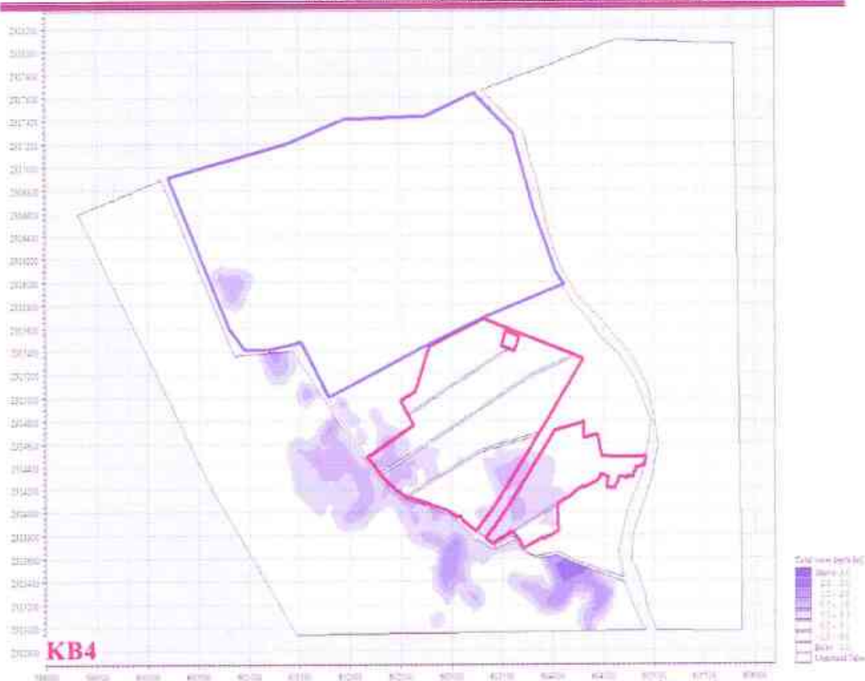
Hình 4. 11. Độ sâu ngập lớn nhất chi tiết khu vực dự án ứng với tần suất P=10\% (KB4)
