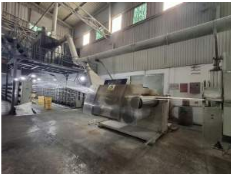
Hình 1. 7. Hình ảnh máy gia nhiệt tạo màng nhựa và xẻ thành sợi
