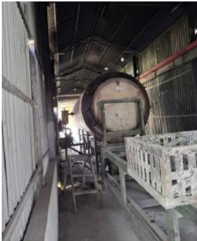
Hình 3. 17. Hình ảnh lò gia nhiệt chân không xử lý lưới lọc thép
