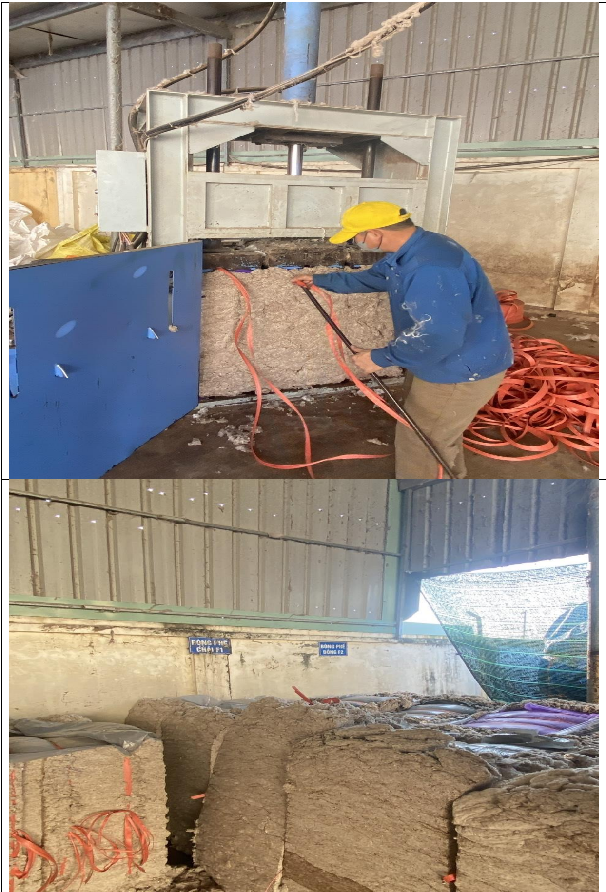
Hình 3. 7 Máy ép kiện và bông phé sau ép lưu giữ tại khu lưu giữ CTR
