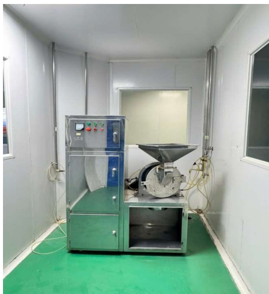
Máy nghiền trong phòng sạch có cửa hút dẫn về hệ thống thu gom lọc khí phòng sạch
